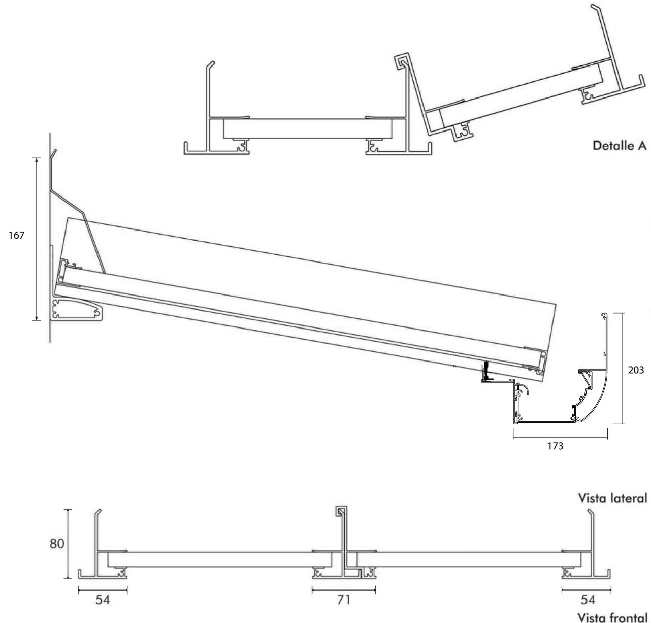
Techo fijo preparado para panel de 16 mm de espesor, pudiendo ser éste de policarbonato celular, o bien, panel sandwich.
